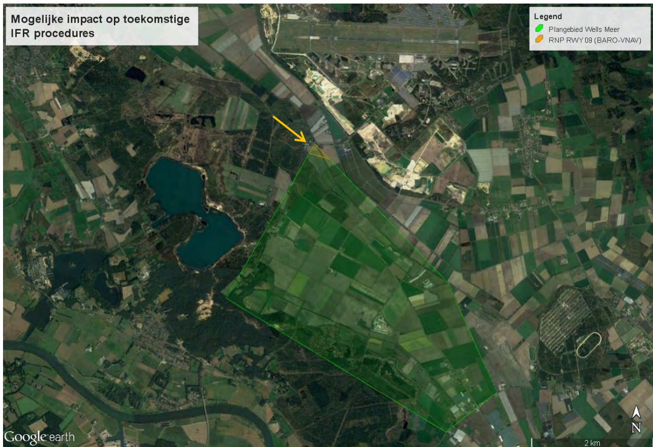
Figuur 3-4: Gebied waarbinnen windturbines mogelijk interfereren met de LNAV/VNAV minima van de RNP (Baro-VNAV) naderingsprocedure van baan 09 als deze in de toekomst worden verlaagd
