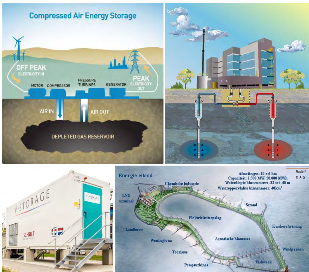
Figuur 6.5: Compilatie van verschillende vormen van energieopslag. Met de klok mee: samengeperste lucht, een WKO-systeem, het Energie-eiland met o.a. pompaccumulatie en een V-storage batterij. (Bron: diversen online)
